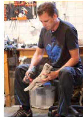
Jens Gürtler bearbeitet das durchgetrocknete Schwemmgut mit einer Schleifmaschine. So löst sich der Sand aus dem Holz
